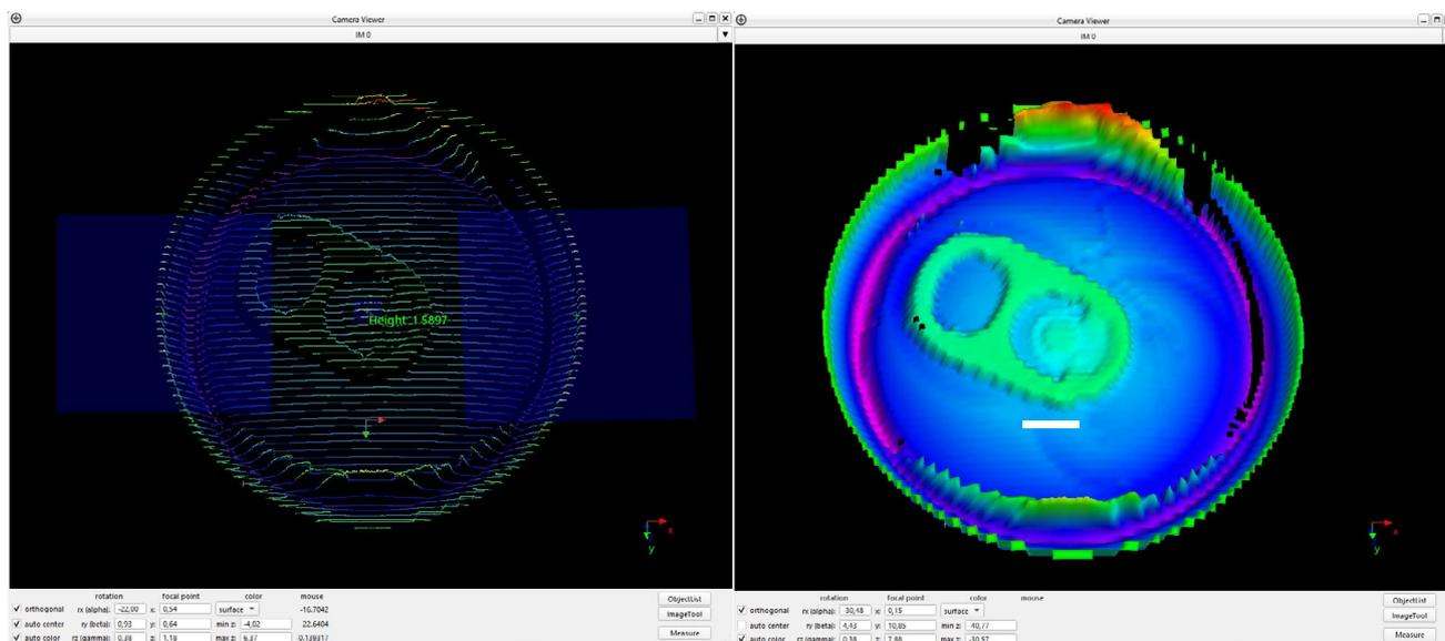
Bild 1 | Mithilfe eines 3D-Sensors von AT Automation Technology werden bei einer Abfüllmaschine im 24/7-Betrieb bis zu 40 Dosen pro Sekunde inspiziert und bewertet. Die Dosen werden direkt auf dem Förderband per 3D-Scan auf ihren Druck geprüft - und das bei maximaler Geschwindigkeit.
